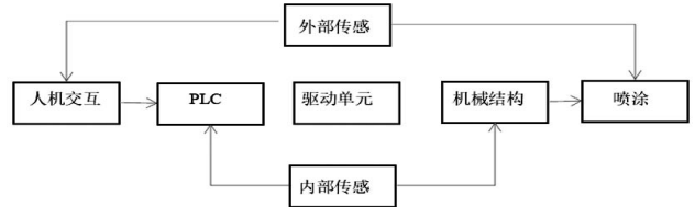
图 3 汽车喷涂机器人控制系统硬件架构
